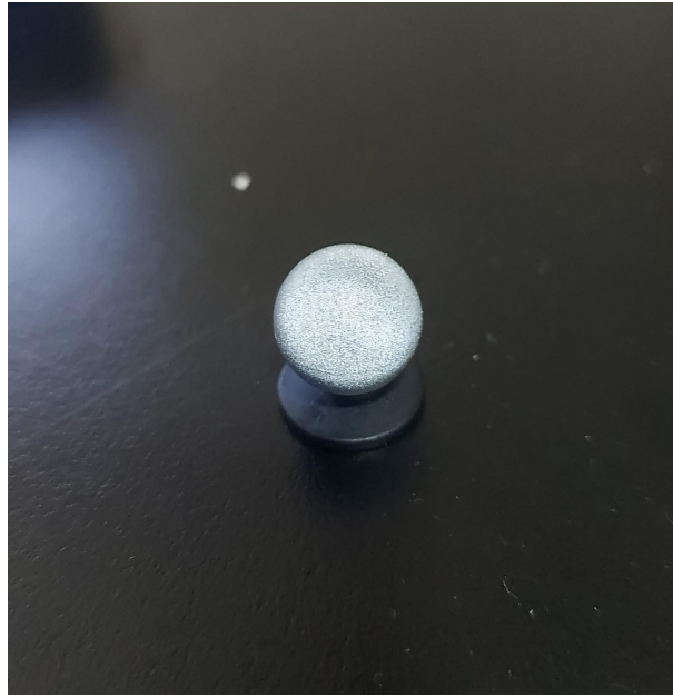
Figura 4.33: Marcador retrorreflectivo para el sistema OptiTrack. Elaboración propia.
