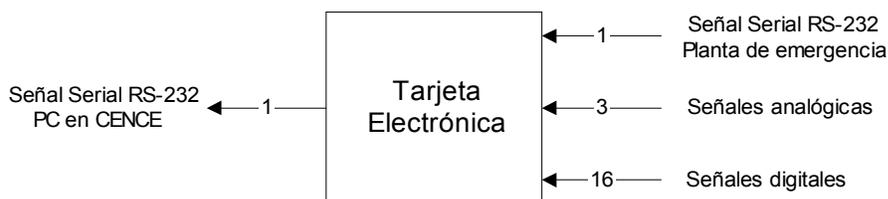
**Figura 6.1** Diagrama de entradas/salidas de la tarjeta electrónica.
