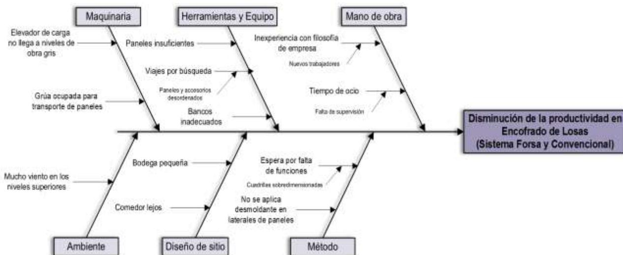
Figura 83. Diagrama de Ishikawa de factores que disminuyen la productividad en el encofrado y desencofrado de losas.
