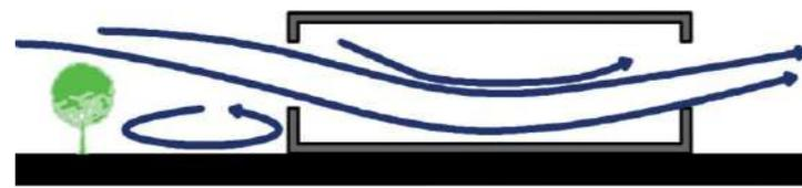
VENTILACIÓN CON UN ARBUSTO A 5M DEL MURO
