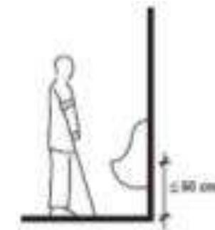
FIGURA 3.31. DETALLE DEL MINGITORIO PARA DISCAPACITADOS.
