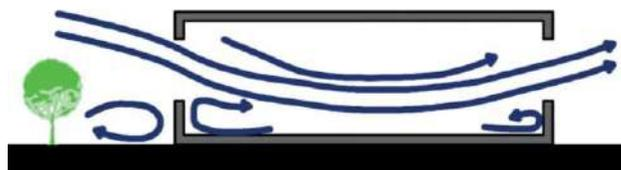
VENTILACIÓN CON UN ARBUSTO A 3M DEL MURO
