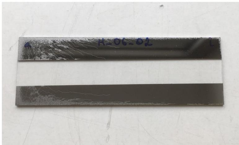
Figura 14. Agrietamiento en una capa de W depositado mediante HiPIMS a 300 W sobre cuarzo. Características del pulso:  $t_{pulse} = 10 \mu s$  and  $f = 2000 \text{ Hz}$ .
