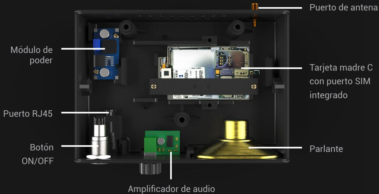
En la figura se muestra el ordenamiento de los componentes internos. Se puede observar que es muy fácil diferenciar cada componente, así como extraerlo y manipularlo porque hay un adecuado margen de espacio entre cada uno.
