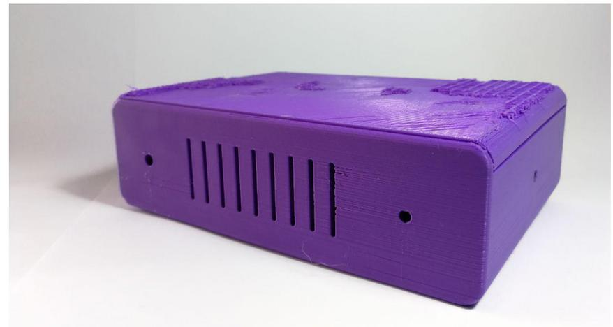
Figura 76. Exterior trasero de prototipo inicial de prueba en material PLA
