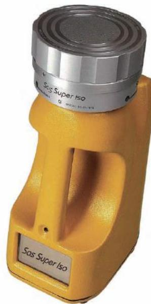
**Figura 4. Equipo de muestreo Surface Air System.**
