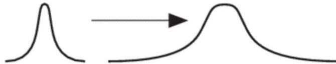
Figura 2.4: Dispersión de una dato debida al canal [3].
