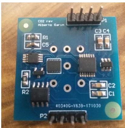
Figura 6.4. Circuito impreso para el sensor de dióxido de carbono
