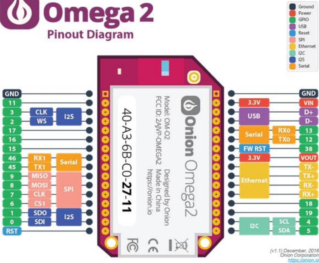
Figura 4.7. Disposición de pines del Onion Omega 2
