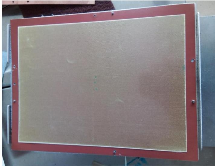
**Figura 4-48.** Orden de los materiales a laminar; encima se muestra el prepreg y debajo la lámina de cobre.
