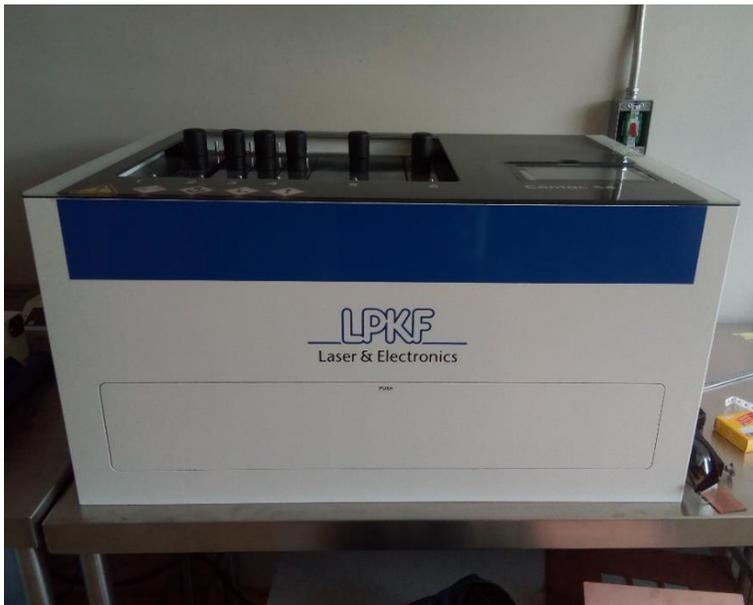
**Figura 4-50.** Compact RS, máquina para el metalizado
