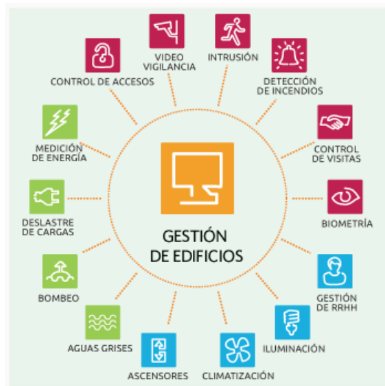
Figura 2.5: Ejemplo de un sistema BMS [4]
