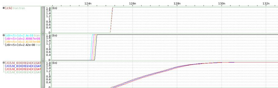
Figura 3.51: Simulación para determinar tiempo de *setup* en 1 lógicos.
