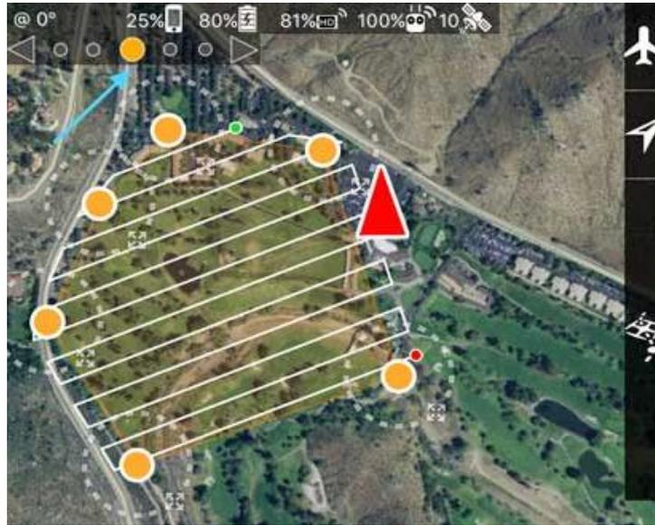
**Figura 3.3** Plan de vuelo programado con una herramienta de software fotogramétrico [31]
