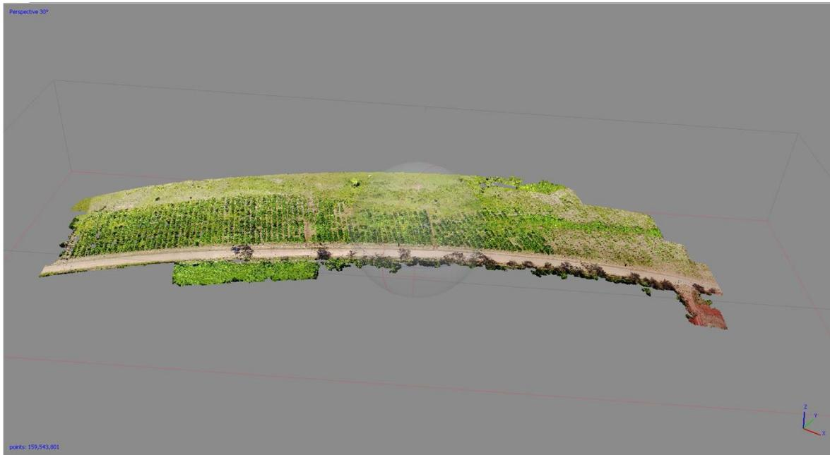
**Figura 4.2** Nube densa de puntos resultante (159 543 801 puntos)
