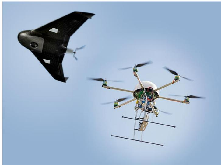
**Figura 2.7** Ejemplos de plataformas de ala fija y multirrotor respectivamente [15]
