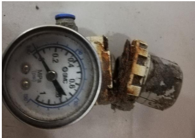
Figura 43 Regulador de Presión defectuoso
