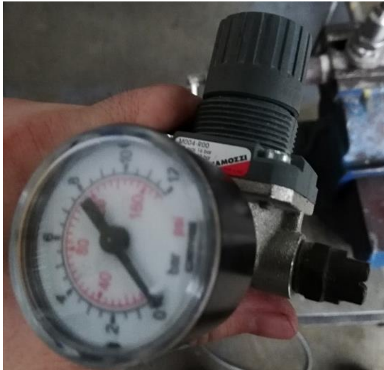
Figura 46 Regulador y boquilla emplea en la estimación del flujo
