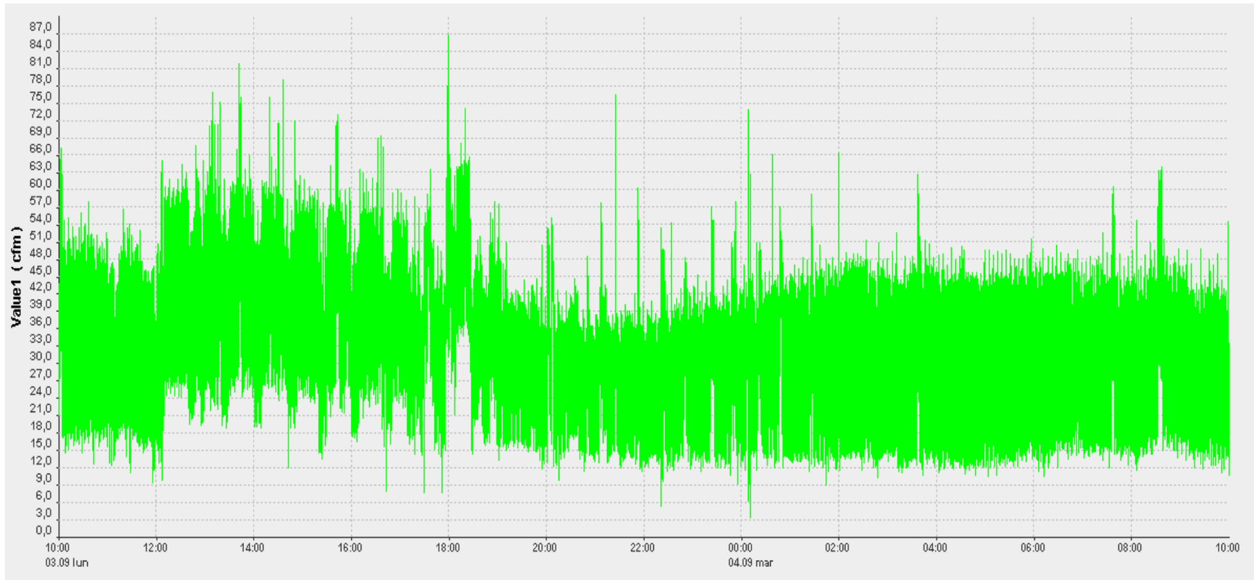
Figura 21 Flujo de aire comprimido en el área de Harinera y Sardina
