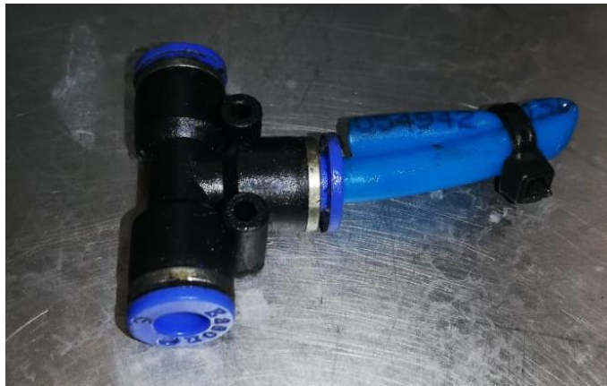
Figura 49 Mala práctica a la hora de eliminar una manguera de aire comprimido
