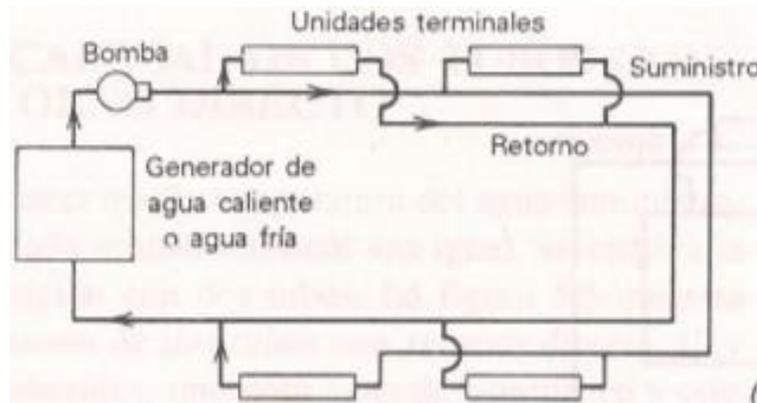
Figura 13. Sistema de tubería con dos cabezales y retorno inverso
