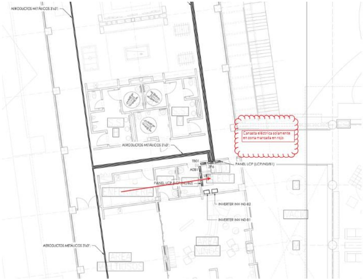
**Figura 78.** Trazo en plano, cambios en canalización eléctrica. Fuente: Elaboración propia
