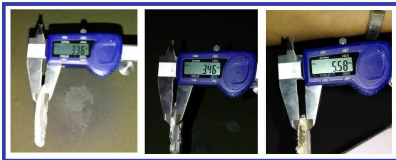
Figura 31. Evidencia fotográfica de la extracción de núcleos de mortero de las zonas 4 y 6.
