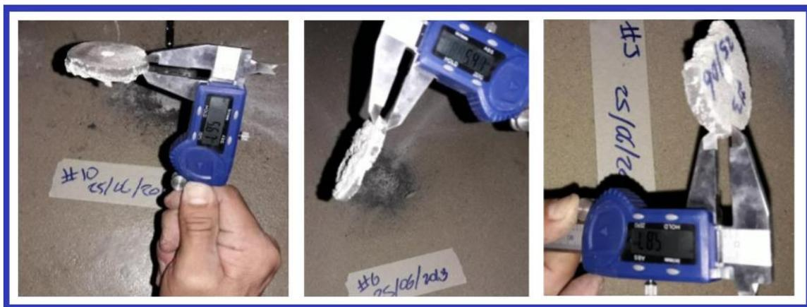
Figura 27. Evidencia fotográfica de la extracción de núcleos de mortero de las zonas 2 y 4.
