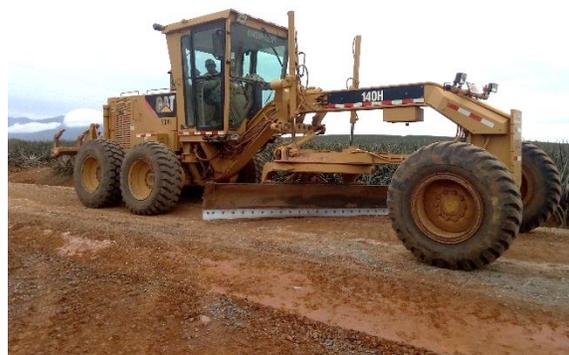
Figura 26. Niveladora CAT 140H.
