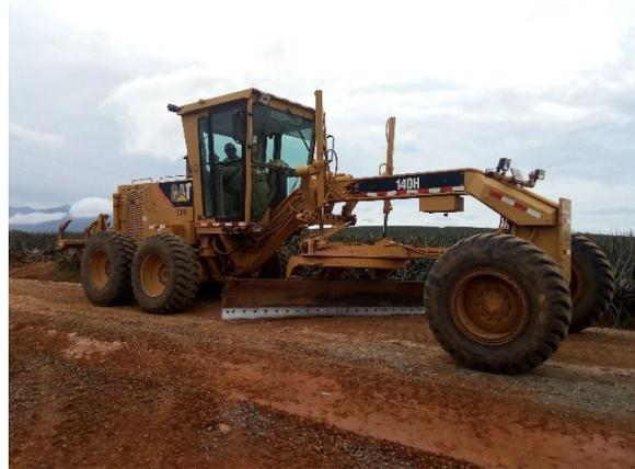
Figura 24. Niveladora CAT 140H.
