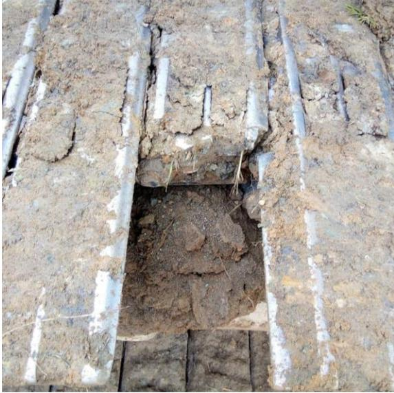
Figura 59. Quebradura de caite en la oruga de la excavadora.
