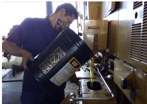
Figura 69. Incorporación de aceite a la niveladora en el taller de la empresa.
