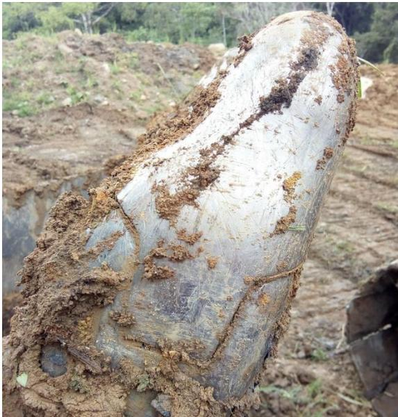
Figura 60. Desgaste de diente del cucharón de la excavadora.
