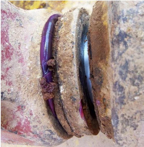
Figura 71. Conexiones engrasadas en excavadora.
