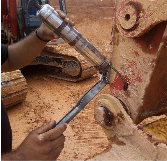
Figura 70. Incorporación de grasa en conexiones de la excavadora.
