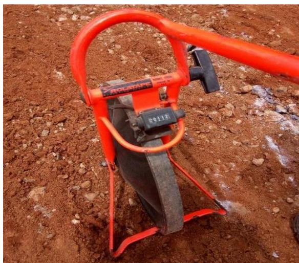
Figura 55. Medición de distancias de trabajo con odómetro.
