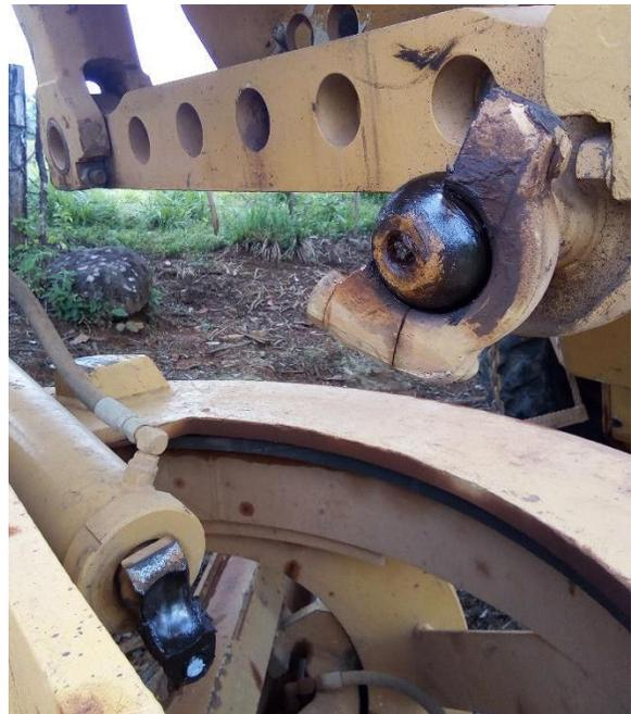
Figura 57. Quebradura de pistón en niveladora.
