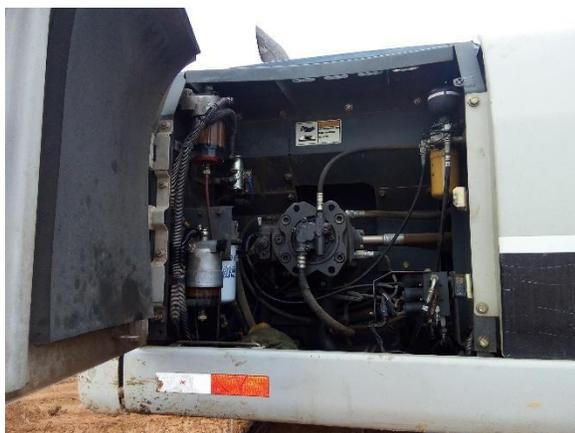
Figura 13. Sistema hidráulico de la excavadora.
