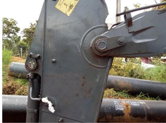
Figura 56. Rompimiento e manguera en excavadora.
