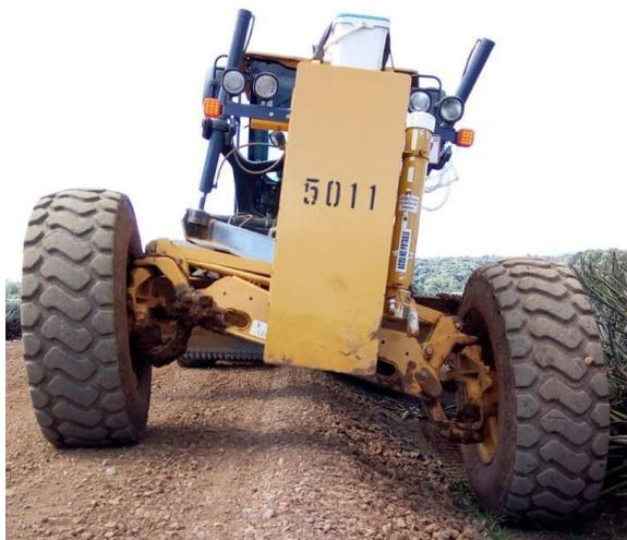
Figura 8. Dirección de eje delantero.
