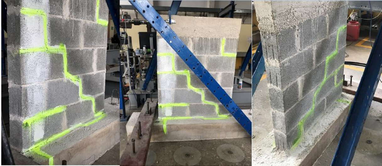
Figura 84. Falla de muestra Muro 1.
