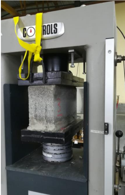
Figura 99. Falla de muestra de bloque de mampostería
