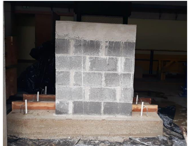
Figura 42. Desencofrado de las muestras
