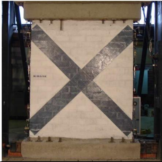
Figura 12. Reforzamiento de FRP en configuración diagonal exterior Fuente: Tomado de Santa María, Alcaino, & Luders, (2006).
