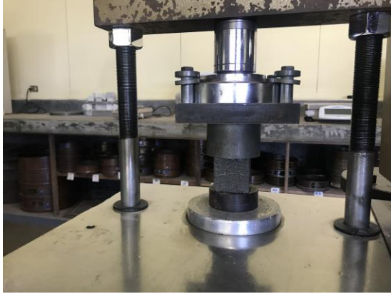
Figura 93. Falla de muestras de mortero de anclaje
