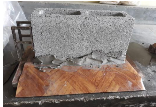
Figura 97. Sellado de celdas de bloques de mampostería
