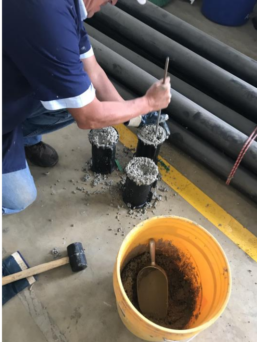
Figura 87. Toma de muestras (cilindros) de concreto estructural
