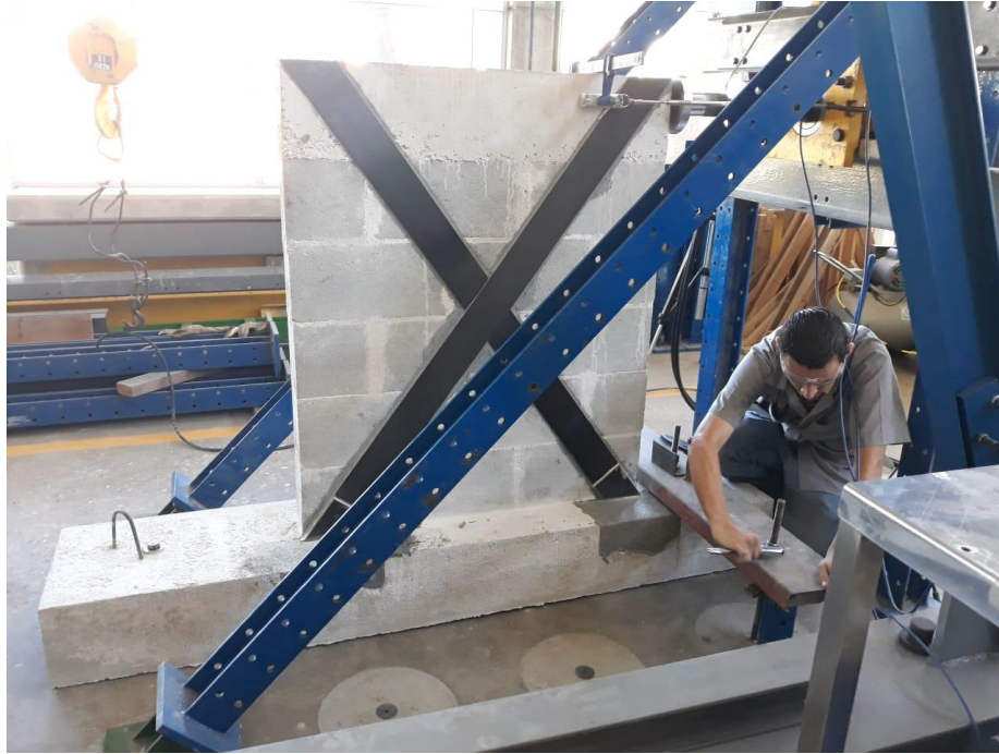
Figura 67. Proceso de fijación de muestra a piso fuerte.
