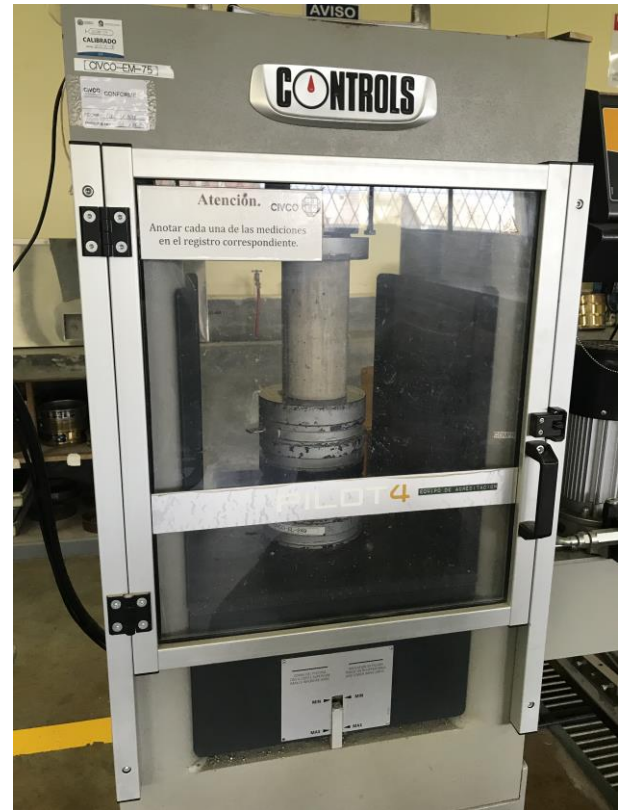
Figura 88. Falla de muestras (cilindros) de concreto estructural
