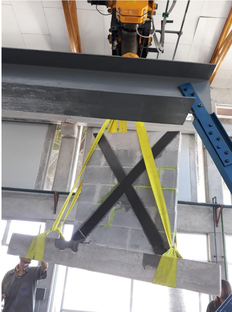
Figura 66. Movilización de muro a zona asignada para la falla.
