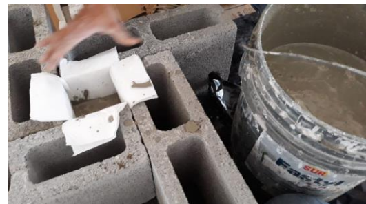
Figura 95. Colado de muestras (prismas) de concreto de relleno
