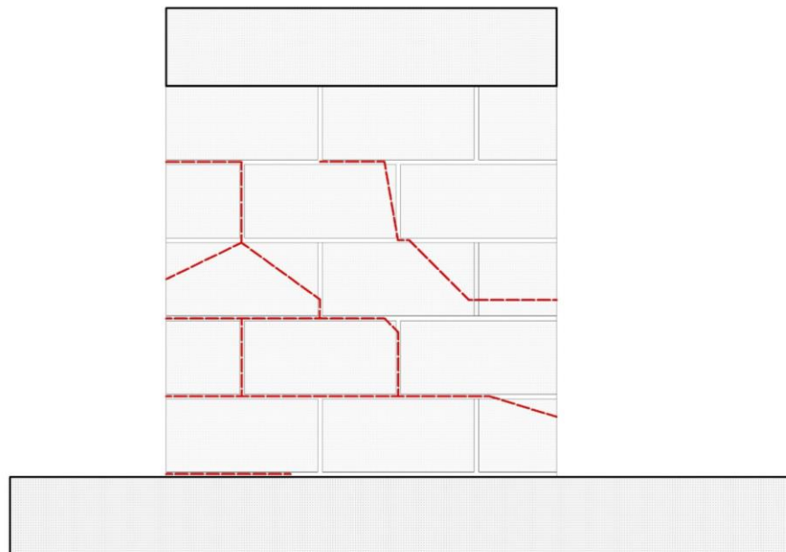
Figura 73. Agrietamiento en cara B de Muro 2
