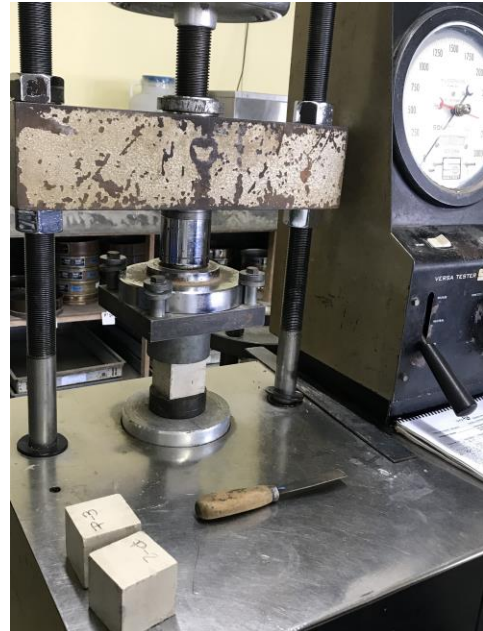
Figura 92. Falla de muestras de mortero de pega
