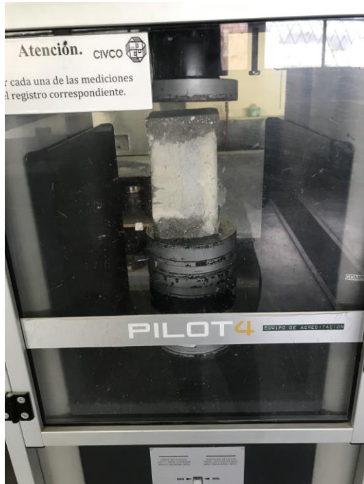
Figura 96. Falla de muestras (prismas) de concreto de relleno
