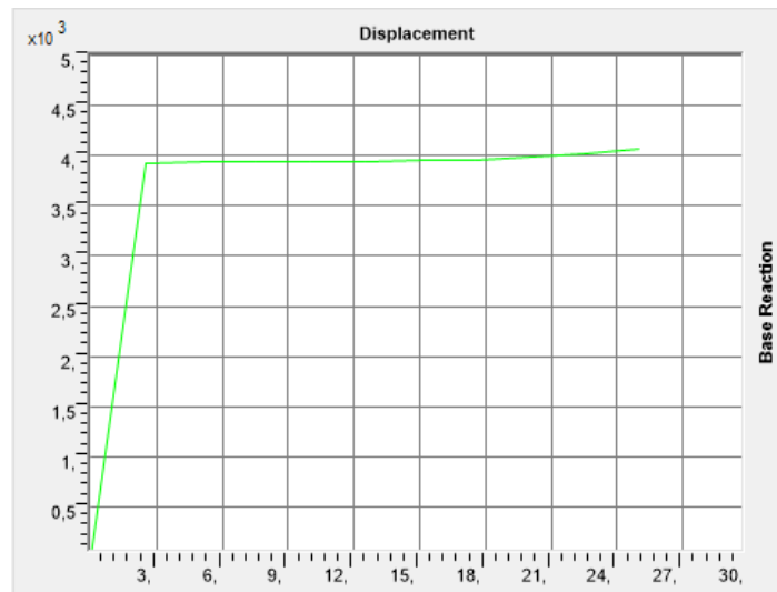
Figura 78. Curva esfuerzo vs deformación para Muro 1
