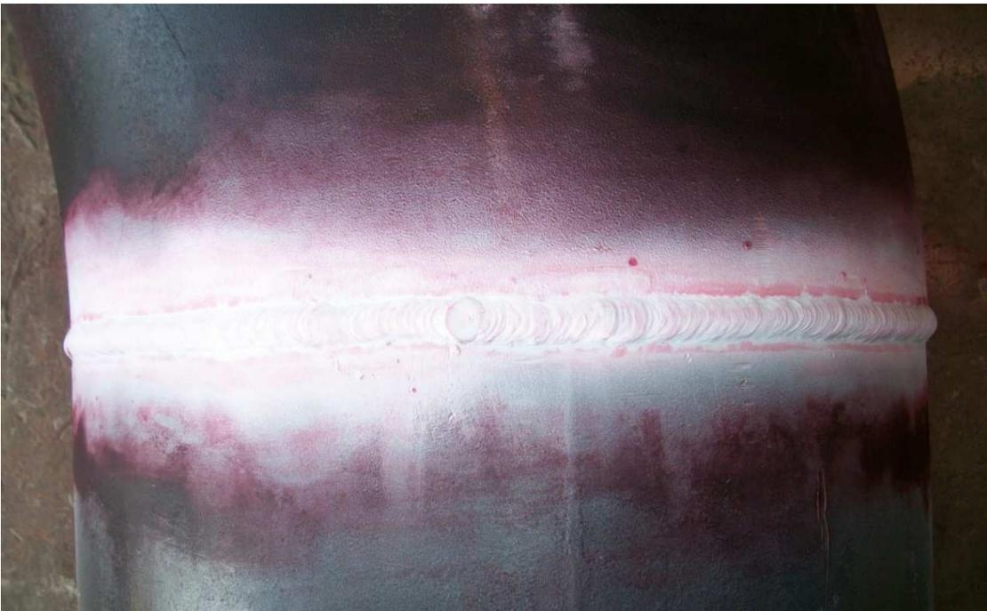
Figura 2. Prueba de líquidos penetrantes aprobada y aplicada sobre un tubo de acero.
