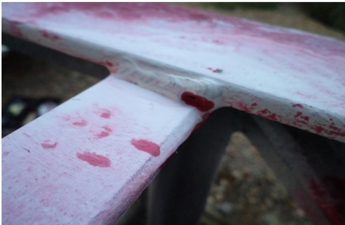
Figura 3. Prueba de líquidos penetrantes rechazada y aplicada sobre un paso elevado de cercha de acero.
