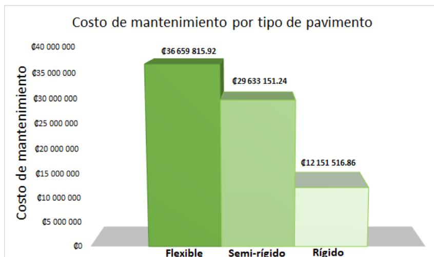
**Figura 61.** Variación del costo de mantenimiento según el tipo de pavimento.
