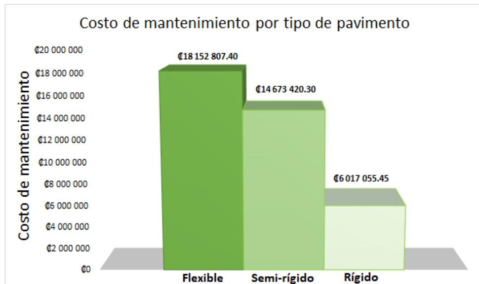
**Figura 62.** Variación del costo de mantenimiento según el tipo de pavimento.
