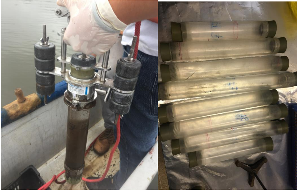
Figura 0.11. Muestreador de sedimentos tipo corer (izquierda) y tubos para recolección de muestra (derecha).
