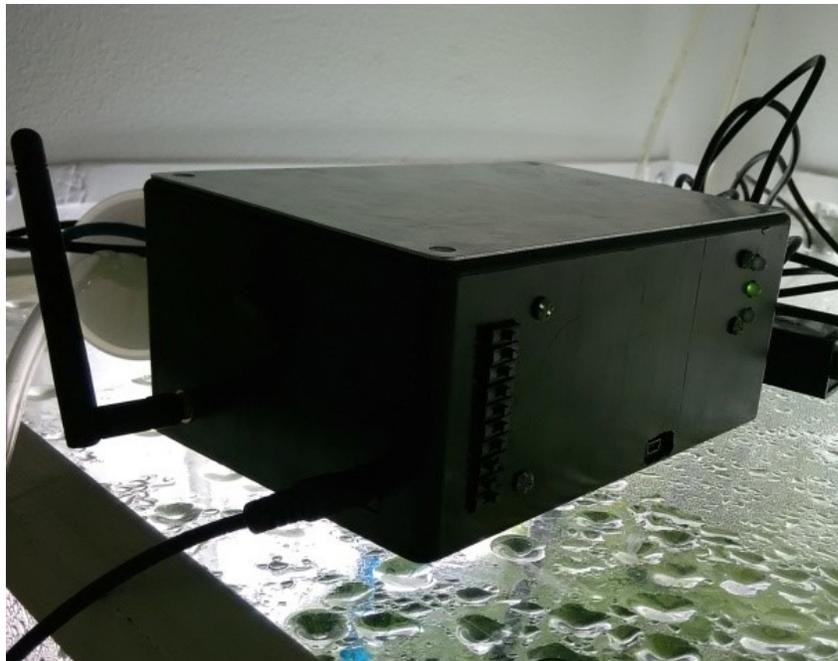
**Figura 5.11:** Dispositivo con conexión a Internet por medio de la red Ethernet. Se realiza la medición de variables relacionadas con el crecimiento microalgal en un PBR, se almacenan los datos localmente y también remotamente en una plataforma con capacidades de IdC [10].
