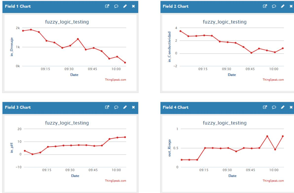
**Figura 5.8:** Datos del controlador de lógica difusa en la plataforma IdC [8]. Se evidencian los cambios en las condiciones de drenaje, conductividad y pH, y la decisión de riego. Es importante destacar que 0.5 indica condición de riego normal, abajo de 0.5 es poco riego y superior es riego abundante.
