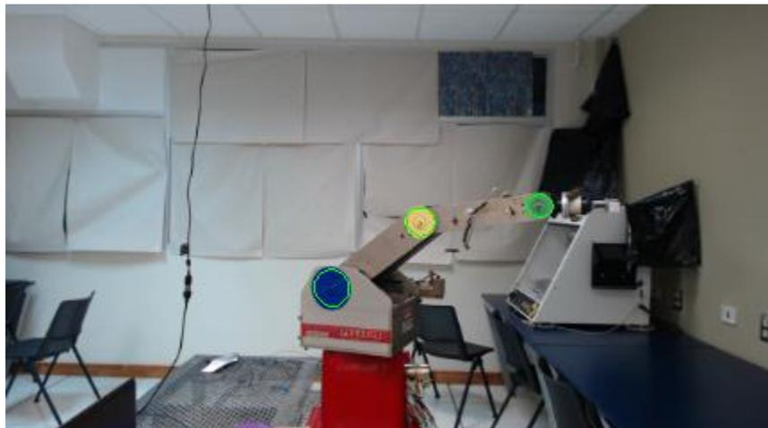
**Figura 6.28** Contornos de detección para una rotación negativa de la base
