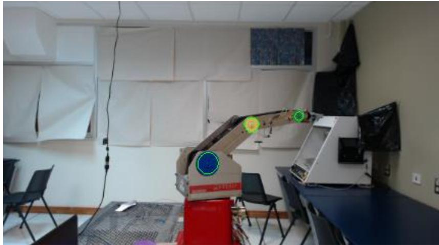
**Figura 6.27** Contornos de detección para una rotación positiva de la base
