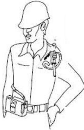
**Figura III. 3. Colocación del tren de muestreo**
