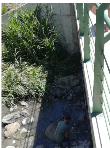
Figura 6.8: Medición manual de la altura de cada puente.
