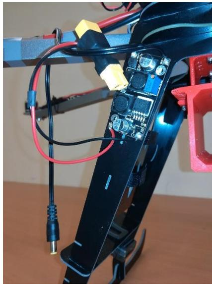
Figura 5.2.7 Circuito adaptador de alimentación de la Mini PC. Fuente: elaboración propia.
