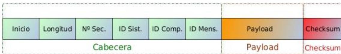
Figura 3.1.3 Estructura de un paquete de información del protocolo MAVLink. Fuente: [6].
