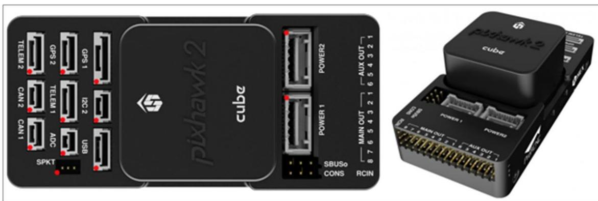
Figura 3.1.4 Vistas superior e isométrica del Pixhawk v2. Fuente: [7]
