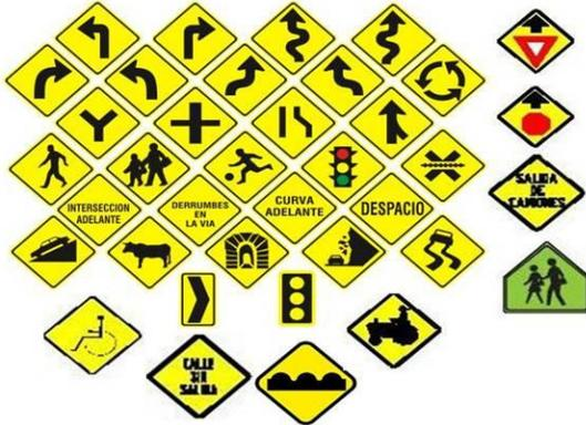
Figura 7. Señalización Vertical
