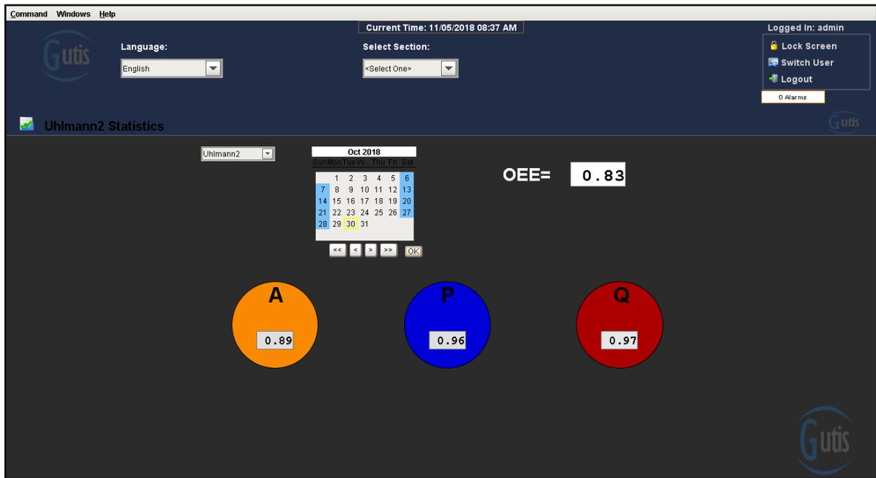
**Figura 6.21** Cálculo de OEE en la plataforma para prueba simulada de la Uhlmann 2 el día 30 de Octubre del 2018.
