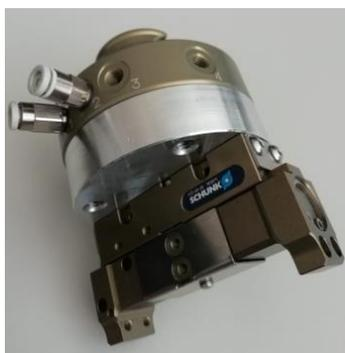
**Figura 43.** Adaptador manufacturado y ensamblado (ver también Figura 42).
