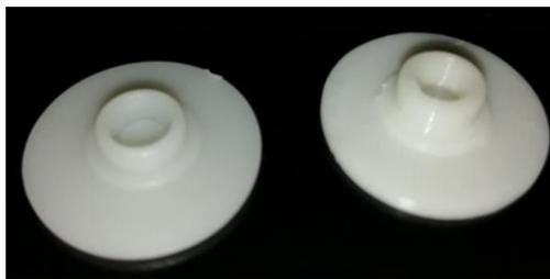
**Figura 11.** Modelo (comprado) vs. Impresión en 3D.
