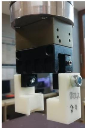
**Figura 27.** Pinzas impresas y ensambladas.
