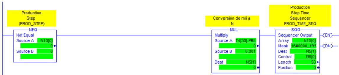
**Figura 5.32** Función secuenciadora para el proceso de producción.
