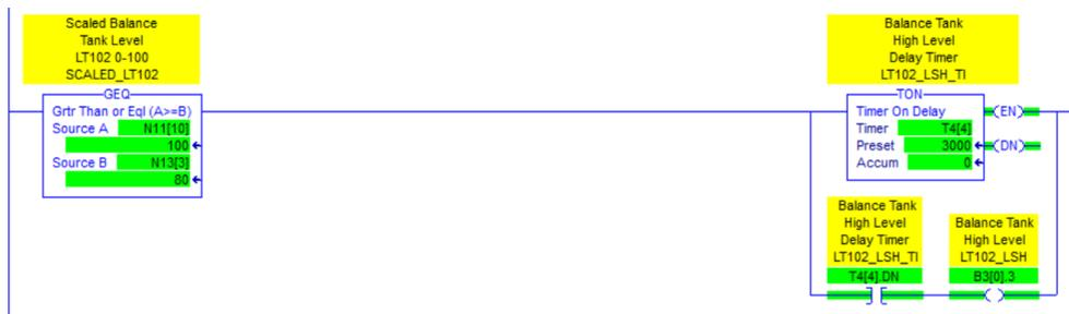
**Figura 5.31** Activación de señal de nivel alto para el tanque de balance en \_3\_MAIN\_SEQ.
