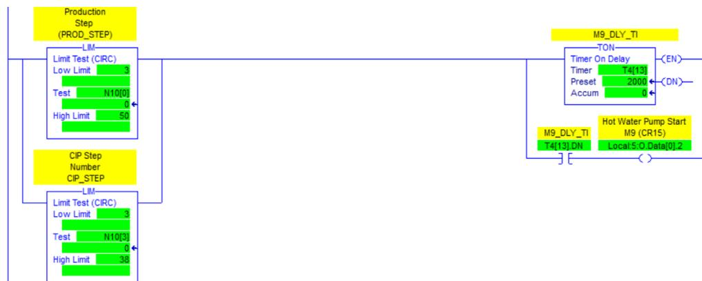
Figura 5.34 Activación de la bomba M9 en \_4\_OUTPUTS.
