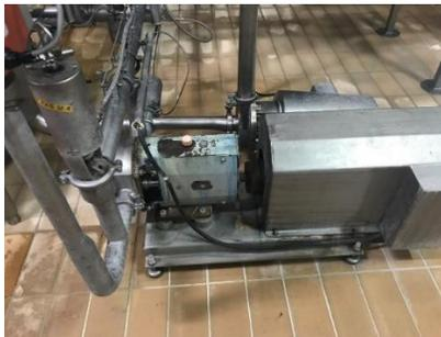
*Figura 3.16 Bomba de desplazamiento positivo M4.*
