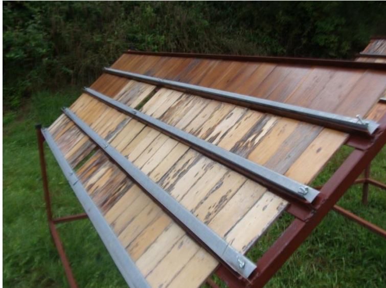
Muestras expuestas a la intemperie natural después de 4 meses de exposición
