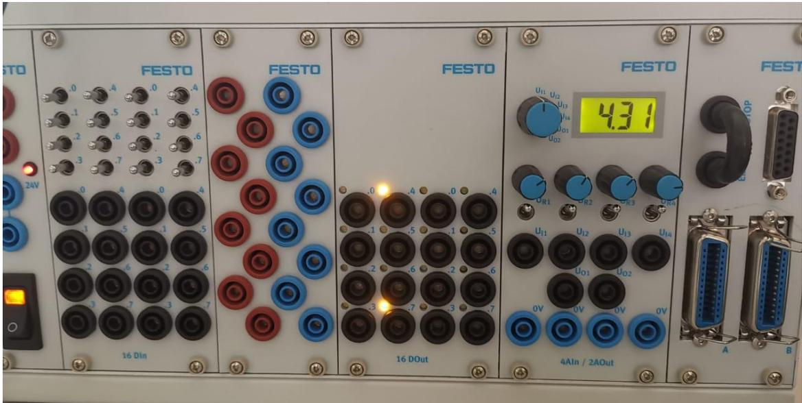
Figura 6. 8 Entrada analógica en la dirección %IW0 para representar el flujómetro
