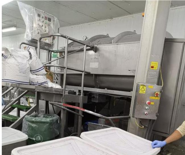
Figura 3. 9 Sistema de mezclado
