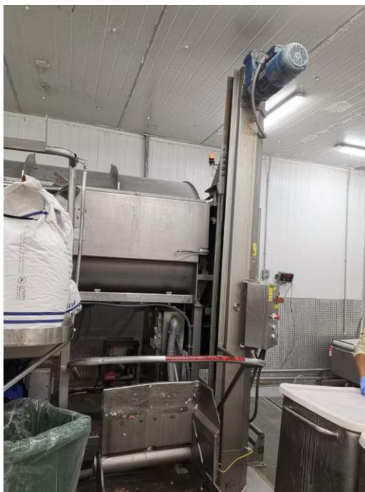
Figura 3. 8 Sistema de elevación de cargas
