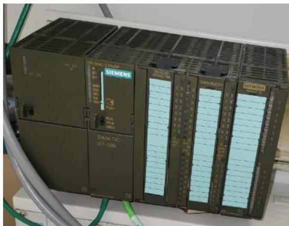
Figura 5. 4 PLC modelo s7- 300 ubicado en SIMTEC.
