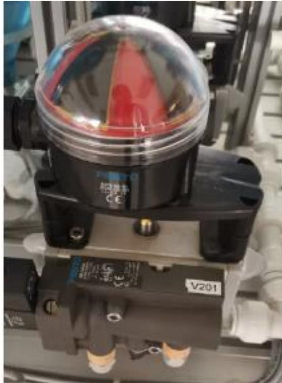
Figura 5. 15 Electroválvula de bola FESTO de 2 vías de accionamiento neumático.
