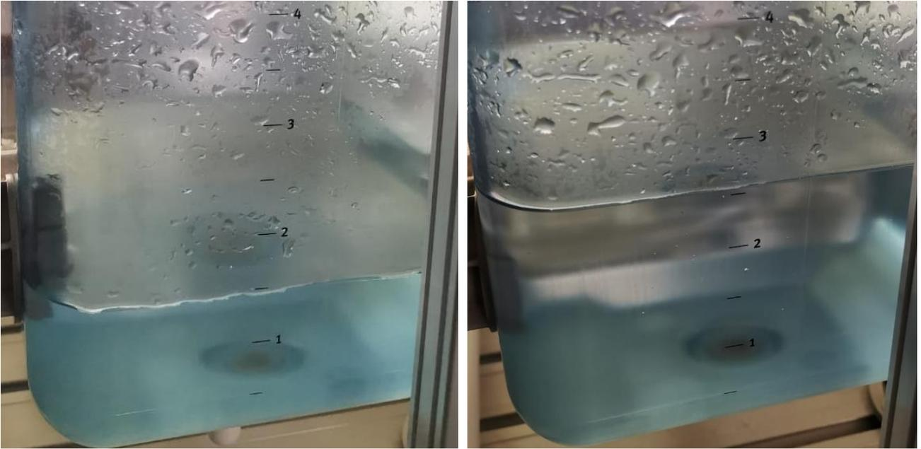
Figura 6. 34 Tanque de recibimiento al dosificar 1 Kg de agua fría
