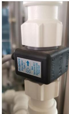
Figura 5. 19 Medidor de caudal de precisión IR-Opflow.
