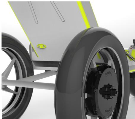
1. Uso de motor de tracción trasera, con nivel de protección IP65.
