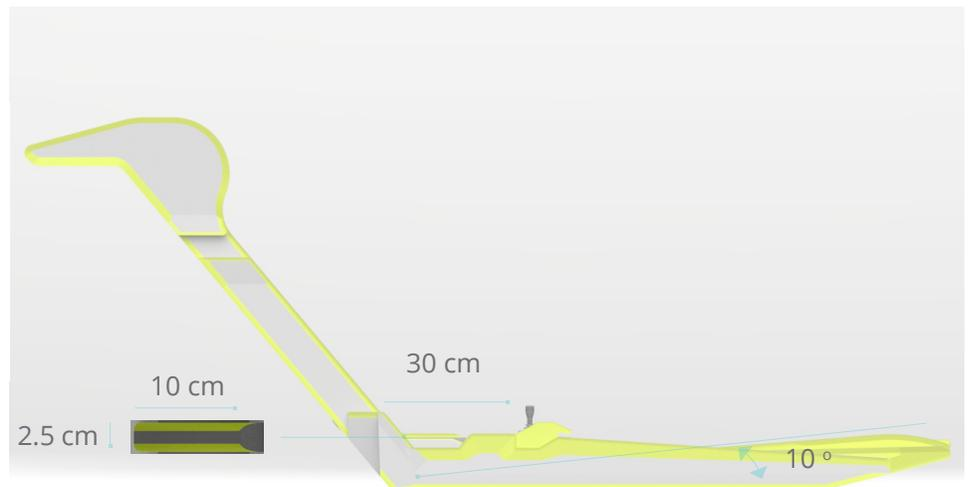
4. Soportes laterales para la estabilidad y control con altura de 10 cm.
