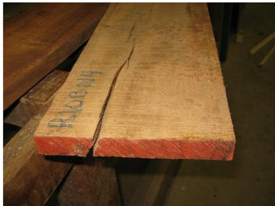
Figura 1. Reventaduras en la madera aserrada de *A. mangium* luego del secado convencional. (Foto: Carolina Tenorio)
