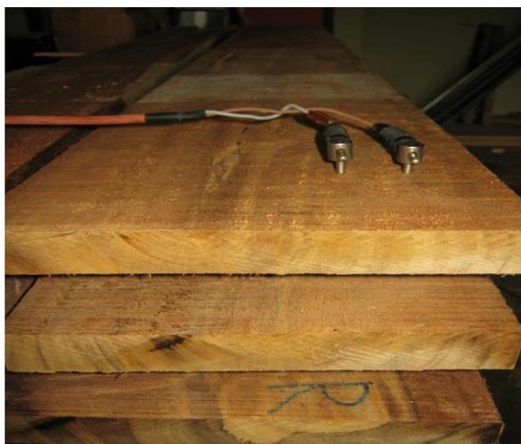
Figura 7. Colocación de la sondas de control de contenido de humedad. Observe que la tabla presenta corte radial y tangencial, la sonda fue colocada en la parte de madera radial. (Foto: Carolina Tenorio)
