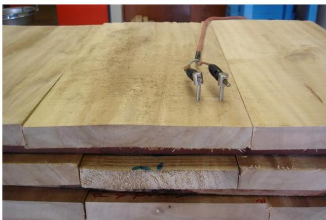
Figura 7. Colocación de la sondas de control de contenido de humedad. Observe que en la tabla presenta madera radial y tangencial, la sonda fue colocada en la parte de madera radial.
