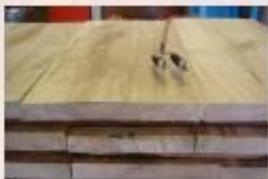
**Figura 6. Colocación de la sonda de control de contenido de humedad.** Observe que en la tabla presente madera radial y tangencial, la sonda fue colocada en la parte de madera radial.
