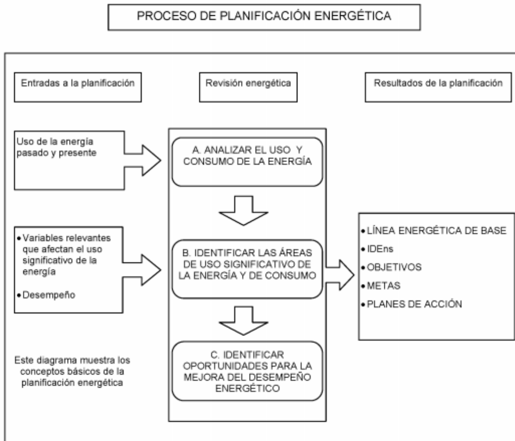
Figura 3.13 Diagrama conceptual del proceso de planificación energética.
