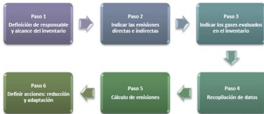
Figura 3.12 Diagrama para aplicación de norma ISO 14064-1 2006.
