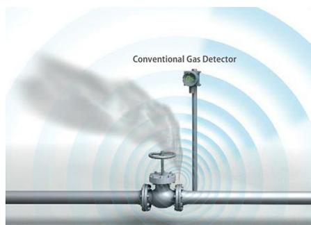
**Figura 44.** Mala colocación de los detectores de amoníaco con respecto a la dirección del viento.
