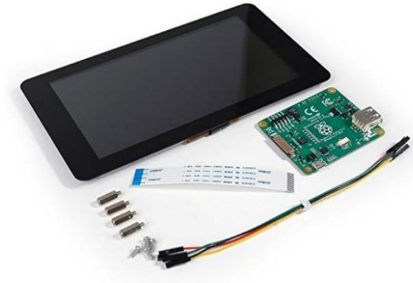
Figura 5.5: Representación de la pantalla LCD utilizada
