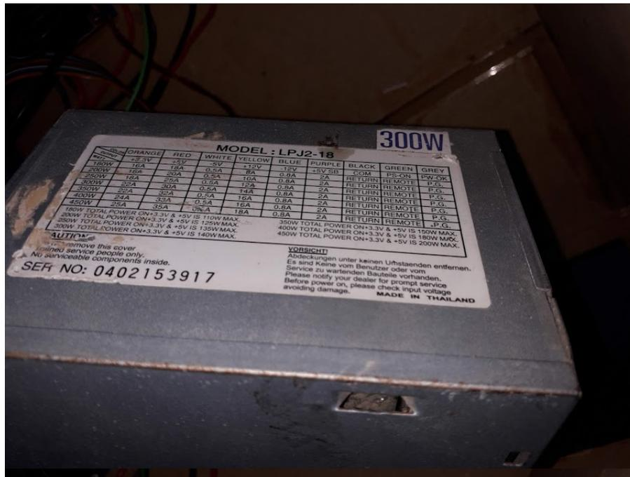
Figura 5.2: Fuente de poder utilizada para dar solución al sistema de potencia.
