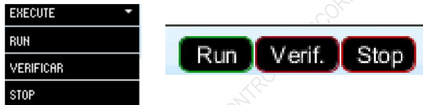
Figura 6. Botones para ejecutar, verificar o parar la ejecución del script de comandos Melfa Basic programados.
