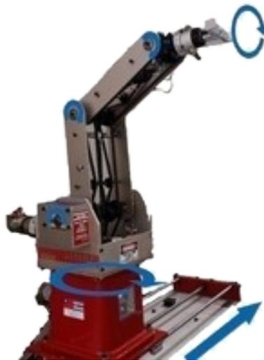
Figura 3.6: Movimientos del Scrobot para la definición del tipo de articulación.
