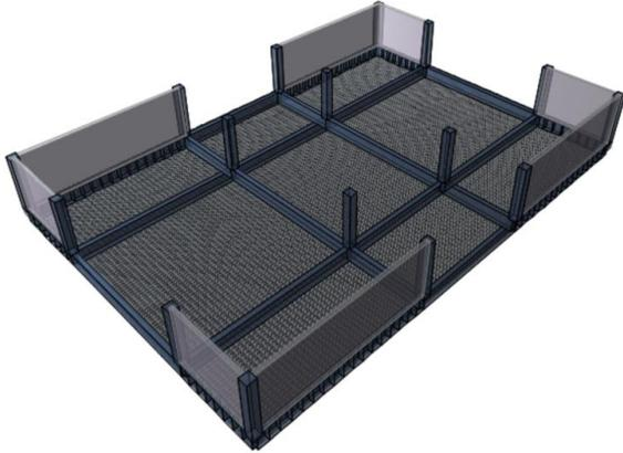
**Figura 26.** Modelo computacional de la losa nervada de fundación para el edificio tipo dual. SAFE v16 ®
