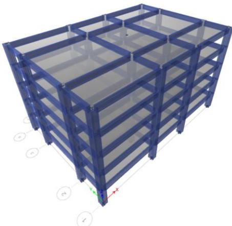
Figura 17. Modelo computacional del edificio tipo marco. ETabs v16 ®
