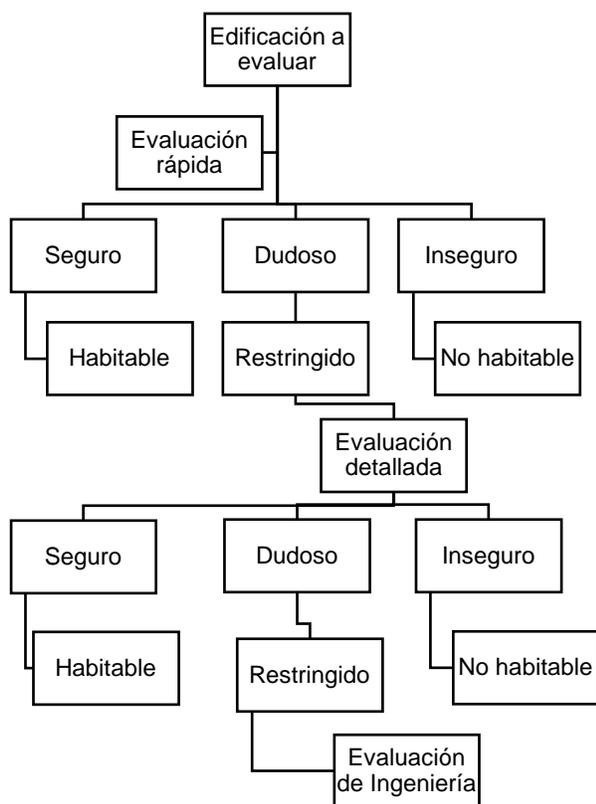
Figura 34. Diagrama de flujo de evaluación estructural
