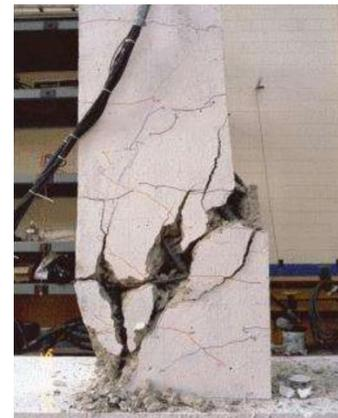
**Figura 7.** Falla por compresión cortante (CENAPRED, 2016)
