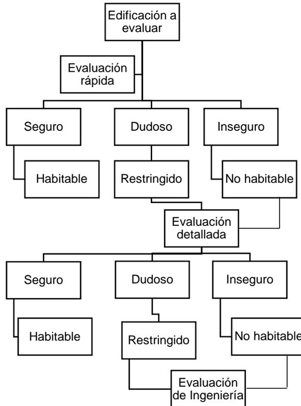
**Figura 1.** Diagrama de flujo de evaluación estructural
