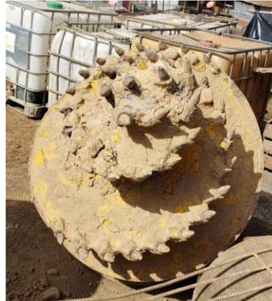
Figura 13. Broca con dientes SR-100 de 1200mm de diámetro. Fuente: El autor,2019.
