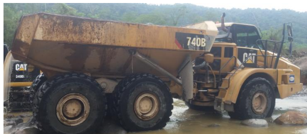
Figura 5. Vagoneta articulada 740B marca Caterpillar Fuente. Fotografía tomada el 01/03/2019
