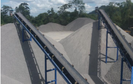
Figura 12. Conveyors que transportan el material hacia los stocks de piedra quintilla y polvo de piedra. Fuente. Fotografía tomada el 01/02/2019
