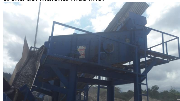
Figura 11. Criba de separación de piedra quintilla y polvo de piedra Fuente. Fotografía tomada el 01/03/2019
