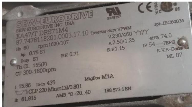
**Figura 4.1.** Placa típica de un motorreductor marca SEW Eurodrive.
