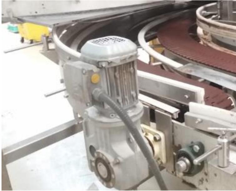
**Figura 4.2.** Motorreductor SEW Eurodrive ubicado en “línea panes”.
