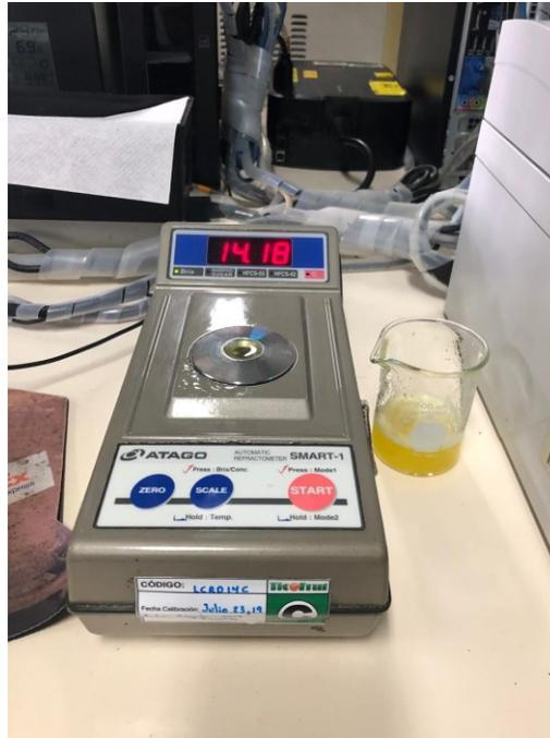
**Anexo 9.** Medición de °brix mediante el refractómetro digital, en el Laboratorio de TicoFrut, Alajuela, Costa Rica, 2018.
