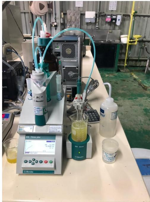
**Anexo 10.** Muestreo de acidez mediante titulación automática en el Laboratorio de TicoFrut, Alajuela, Costa Rica, 2018.
