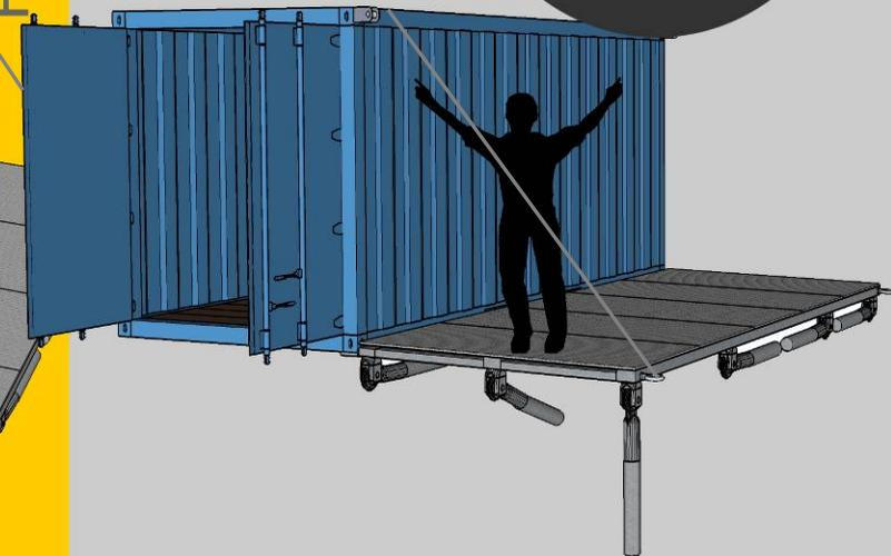
Fig.58 Funcionamiento plataformas de extensión . Fuente: propia
