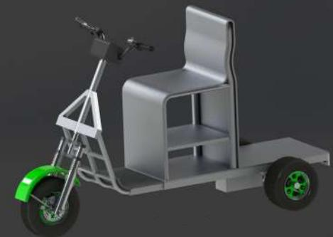
Figura 106: e-correio, componentes colocadas encima del chasis y demás partes soldadas
