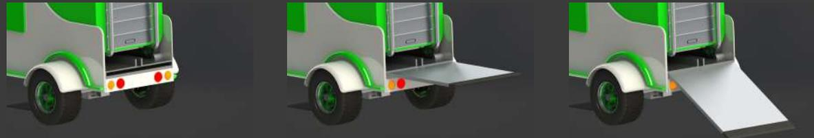
Figura 101: e-correio, representación de la salida de la rampa 2
