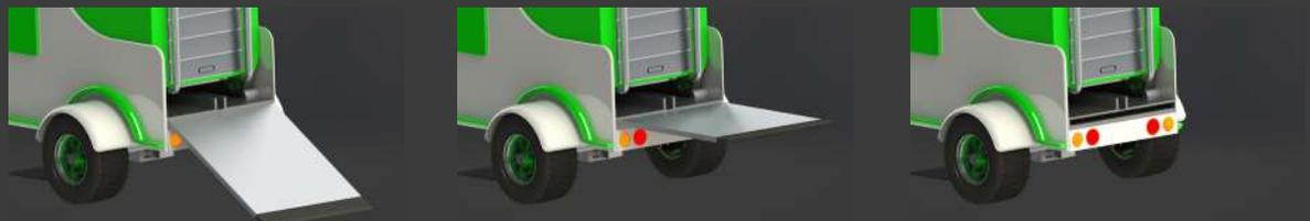
Figura 102: e-correio, representación de la entrada de la rampa 2
