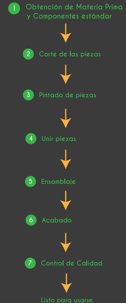
Figura 109: e-correio, flujograma del proceso de manufactura
