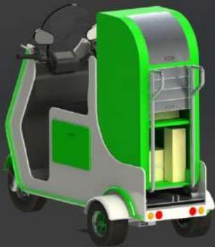
Figura 67: e-correio, accesorio de carga abierto en el vehículo
