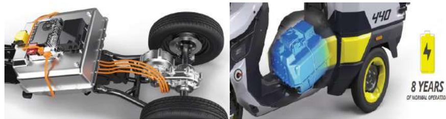
Imagen 75: Collage de imágenes de los componentes internos eléctricos del Rapide 3
