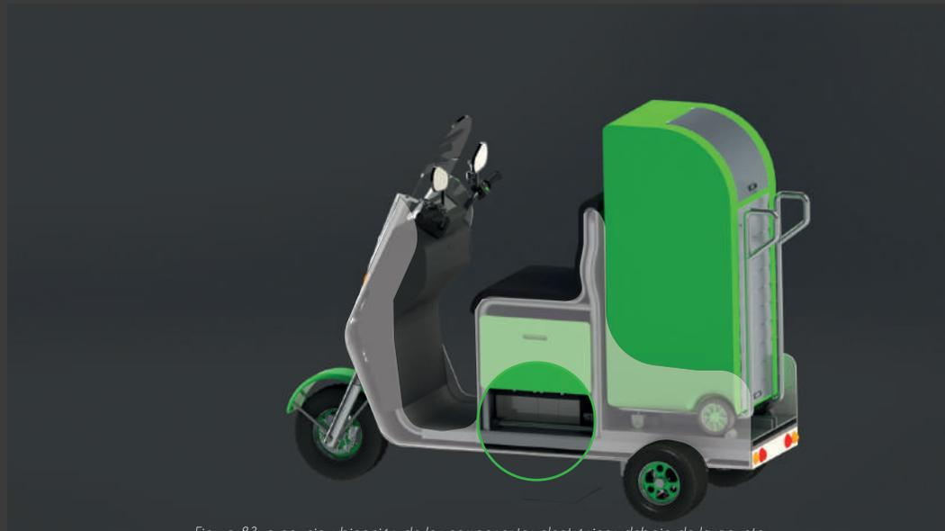
Figura 83: e-correio, ubicación de los componentes electrónicos debajo de la gaveta
