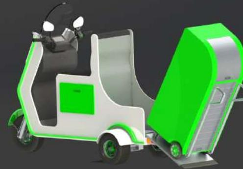
Figura 95: e-correio, representación de cómo baja el accesorio de carga
