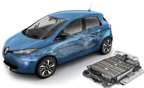
Imagen 138: Localización de la batería de un auto eléctrico
