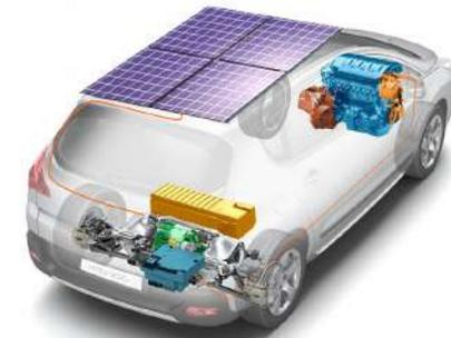
Imagen 116: Esquema de un Carro Solar
