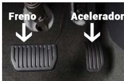
Imagen 148: Dos pedales separados para el freno y el acelerador
