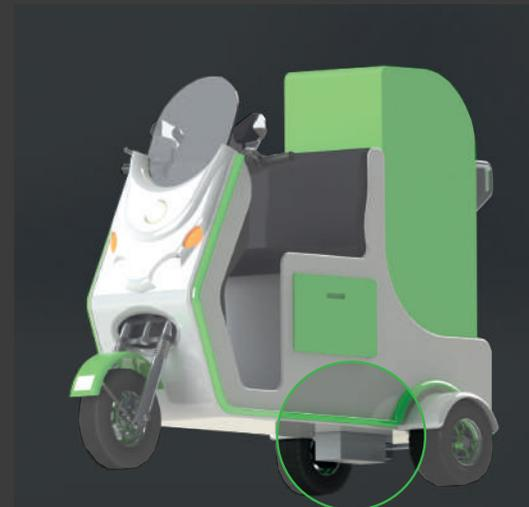
Figura 85: e-correio, ubicación del motor en el vehículo
