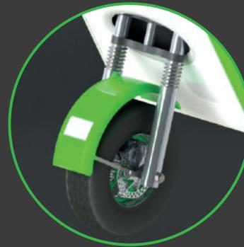
Figura 74: e-correio, freno de disco en la rueda delantera y la suspensión en la horquilla
