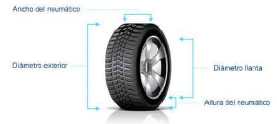
Imagen 157: Medidas de un Neumático
