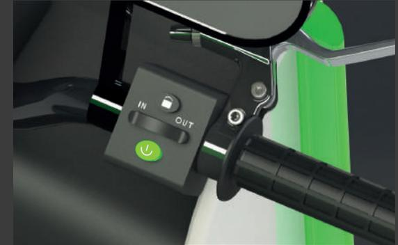
Figura 100: e-correio, interruptor de la salida o entrada de la rampa
