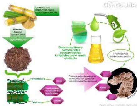
Imagen 125: Esquema de los Biocombustibles
