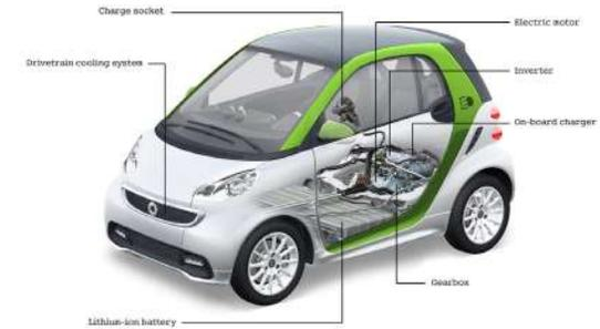
Imagen 133: Componentes de un auto eléctrico 2
