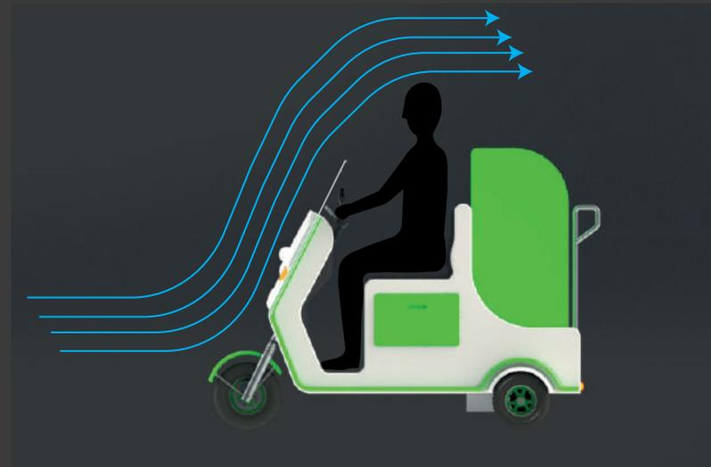
Figura 78: e-correio, flujo del aire en el vehículo gracias al parabrisas
