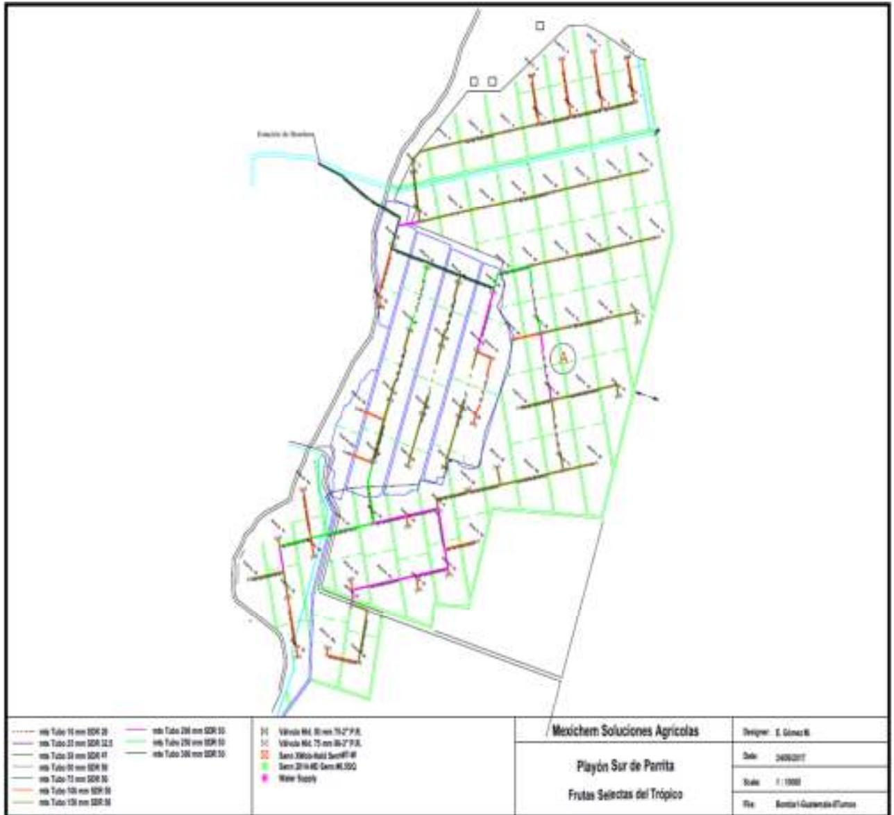
Figura 8.4 Plano del diseño hidráulico de la red principal de la bomba N°1, “El Chileno”
