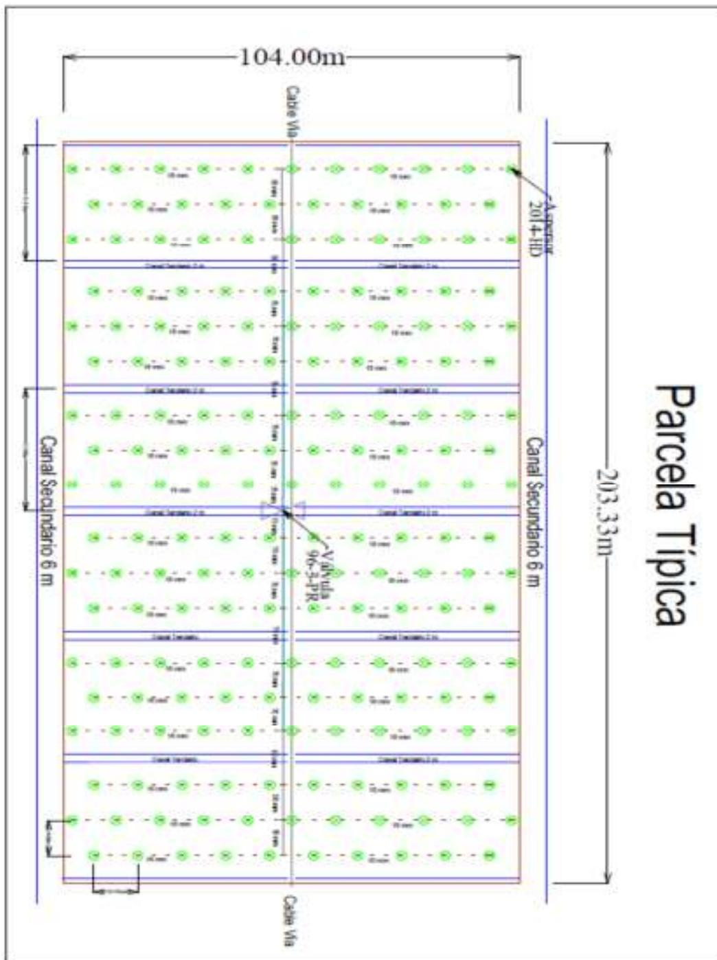
Figura 8.2 Plano de información de campo de fincas “El Chileno” y “Jicote” con información topográfica de curvas de nivel, dimensión de canales primarios, secundarios y terciarios.
