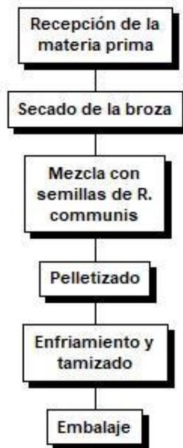
Figura 9. Diagrama del proceso industrial del pelletizado.
