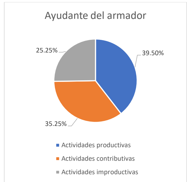
Figura 5. 19 y Figura 5. 20, al sumar el total de cada tipo de actividad. Se puede observar una productividad mayor por parte de ayudante, sin embargo, cabe destacar que realiza las mismas tareas que el armador.
