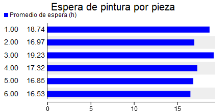
Figura 5. 58. Tiempo de espera de pintura por pieza según el modelo de simulación. Fuente: FlexSim 2019.
