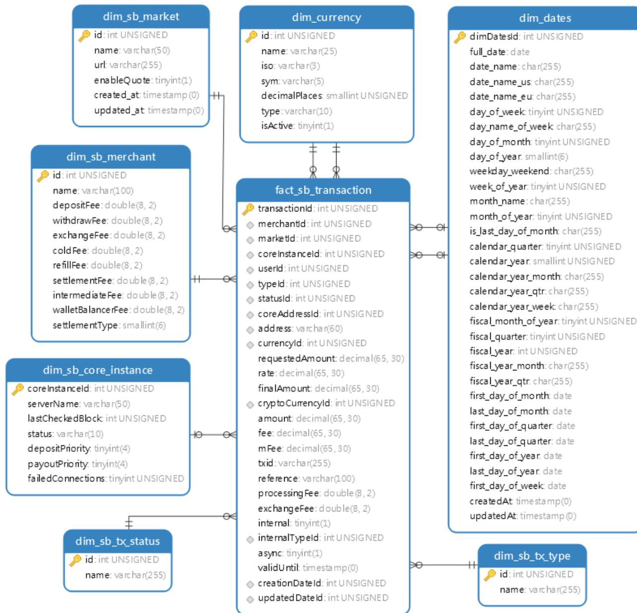
*Figura 16. Diseño físico del modelo estrella de transacciones del procesador de criptomonedas. Fuente: elaboración propia. (2020).*
